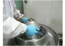
セパレータの分解・整備
